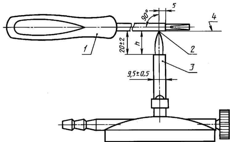
1 — образец инструмента; 2 — конец языка пламени; 3 — горелка; 4 — горизонтальная линия отсчета;
