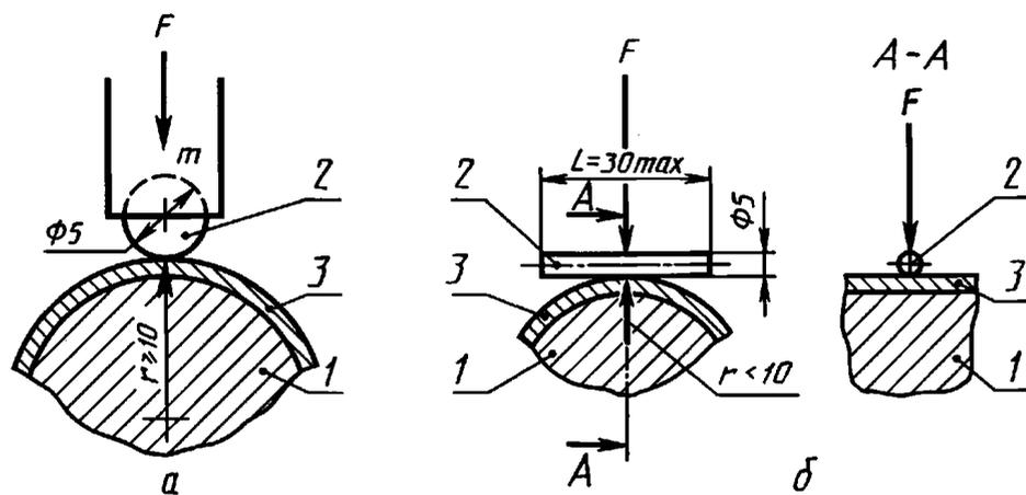
*a* — радиус прогиба инструмента в точке испытания  $\geq 10$  мм: 1 — проводящая часть; 2 — полусферическая деталь; 3 — изоляция (в испытуемой точке); *r* — радиус прогиба инструмента в месте испытания; *m* — масса, воздействующая на инструмент при испытании; *б* — радиус прогиба инструмента в точке испытания  $< 10$  мм: 1 — проводящая часть; 2 — цилиндрический стержень; 3 — изоляция (в испытуемой точке); *r* — радиус прогиба инструмента в месте испытания
