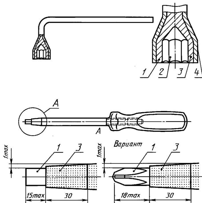
1 — проводящая часть; 2 — рабочая часть; 3 — изоляция; 4 — зона контакта
