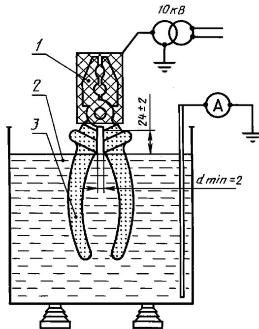
1 — проводящая рабочая часть; 2 — ванночка с водопроводной водой; 3 — изолированная часть инструмента;  $d$  — расстояние, которое необходимо поддерживать между внутренними поверхностями рукояток
