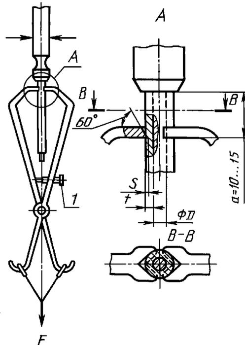
*I* — регулирующее устройство; *S* — глубина проникания ( $S = 0,5 \cdot t \text{ max}$ ); *t* — толщина изолирующего покрытия; *F* — прикладываемая сила; *a* — расстояние между точкой приложения режущей кромки испытательного устройства и соединением рукоятки со стержнем
