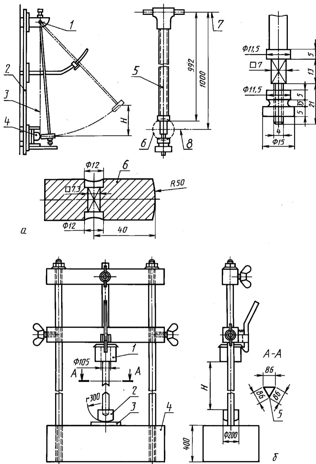
*a* — метод А: 1 — ось регулируемого колебания; 2 — стойка; 3 — вертикальная плоскость прохождения оси маятника; 4 — образец инструмента; 5 — стальная трубка внешним диаметром 9 мм, внутренним — 8 мм; 6 — молоток; 7 — ось колебания; 8 — ось молотка; *H* — высота падения молотка.
