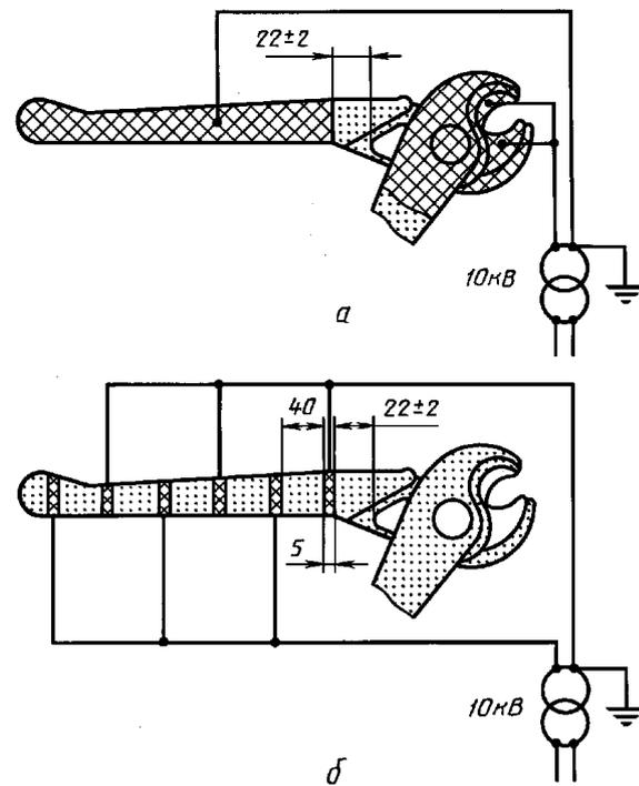
$a$  — электрическое сопротивление между рабочей частью и ручкой инструмента;  $b$  — электрическое испытание рукояток инструментов
