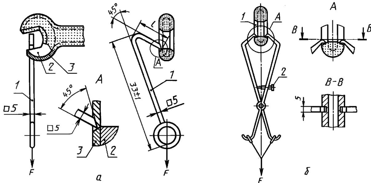
*a* — метод А — Испытание рабочей части инструмента: 1 — крюк (его длина зависит от размеров инструмента); 2 — проводящие части; 3 — изолирующее покрытие; *l* — длина изогнутой части крюка; *б* — метод Б — Испытания рабочей части инструмента: 1 — деталь А; 2 — регулирующее устройство
