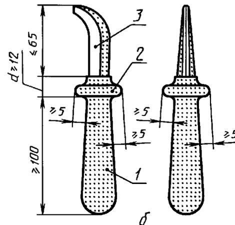
1 — изолированная ручка (или рукоятка); 2 — предохранительный упор; 3 — рабочая головка (неизолированная);
