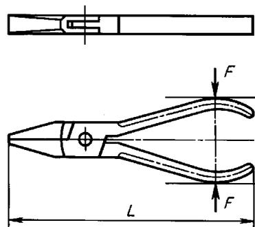
Рисунок 12 — Изолирующие плоскогубцы. Испытание рукояток на изгиб
